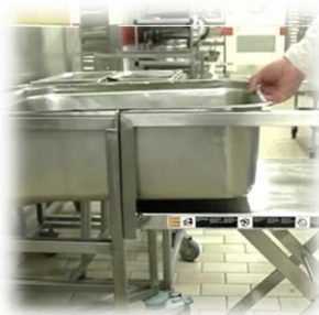
Zoom sur le système de transfert de bac GN
