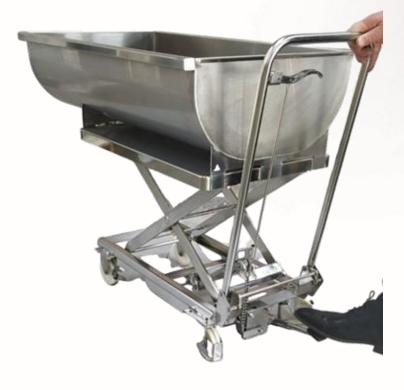
Cuve avec rebords adaptés pour positionnement bac GN 1/1 en suspension
